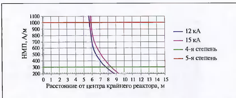
Рис. В.32. Распределение НМП при аварийных режимах (трехфазное КЗ) в вертикальной плоскости при Z = 0,96 \text{ Ом} ; n = 45 ; R = 0,9 \text{ м} ; s = 2,4 \text{ м}
