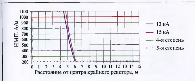
Рис. В.18. Распределение НМП при аварийных режимах (трехфазное КЗ) в вертикальной плоскости при Z = 0,25 \text{ Ом} ; n = 34 ; R = 0,6 \text{ м} ; s = 2,4 \text{ м}
