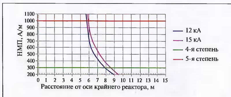
Рис. В.12. Распределение НМП при аварийных режимах (трехфазное КЗ) в вертикальной плоскости при Z = 0,96 \text{ Ом} ; n = 45 ; R = 0,9 \text{ м} ; s = 2,4 \text{ м}
