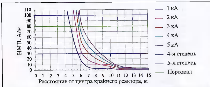
Рис. В.26. Распределение НМП при нормальных режимах в вертикальной плоскости при Z = 0,25 Ом; n = 34 ; R = 0,6 м; s = 2,4 м
