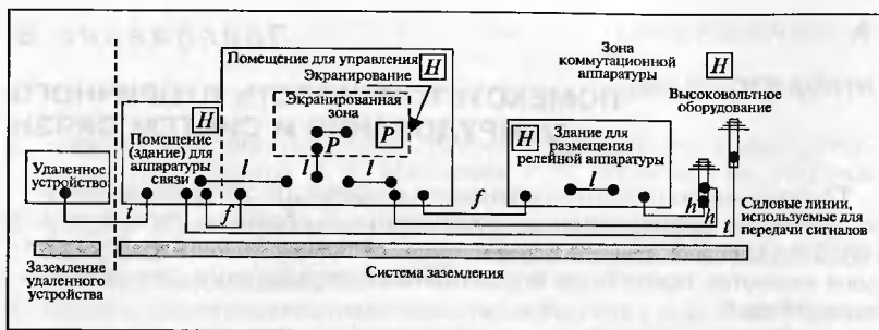
Рис. Б.2. Виды соединений на подстанции.
